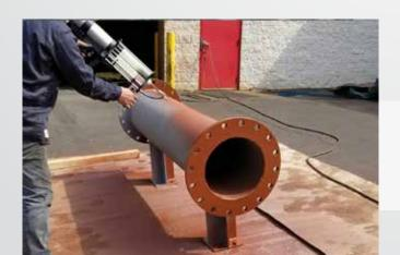
Pour les grandes surfaces, le temp d'application peut être considérablement réduit avec le **pistolet MeCaSpray**. L'équipement MeCaSpray peut être utilisé avec les cartouches suivantes:
